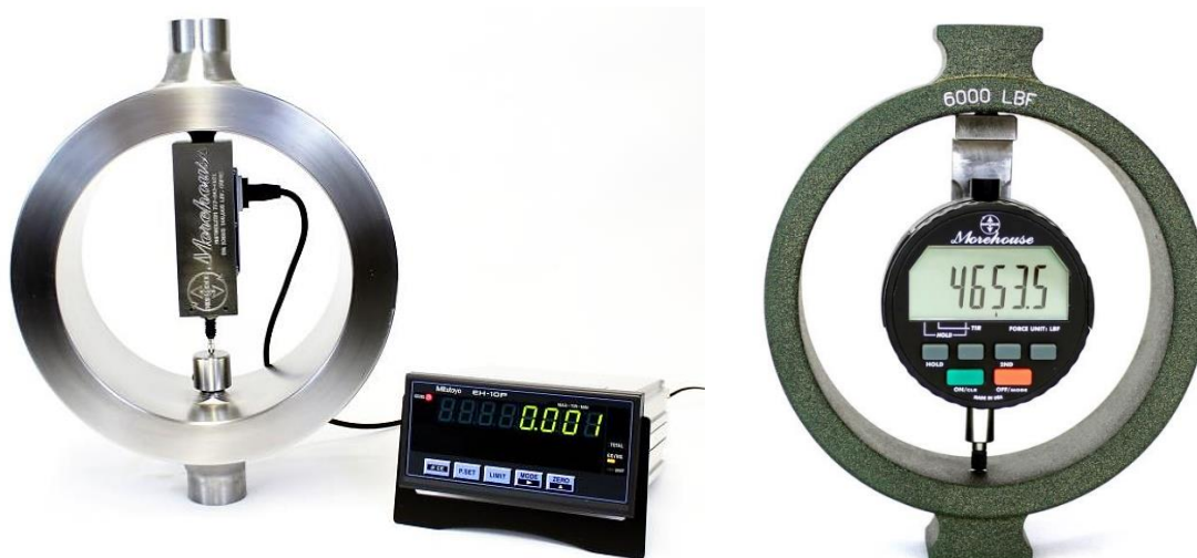
Obr. 23 – Digitální prstencové měřiče síly, zdroj (Morehouse Instrument Company, 2023)
