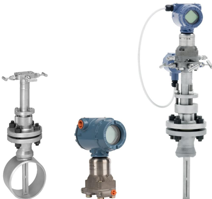
Obr. 14 – Průtokoměr Rosemount Annubar s několikaotvorovou rychlostní sondou: sonda s T průřezem vč. osazení pro montáž hlavice (vlevo), hlavice s převodníkem (uprostřed), kompletní senzor pro měření diferenciálního tlaku doplněný o senzor teploty (vpravo), zdroj (Emerson Electric, 2023b)
