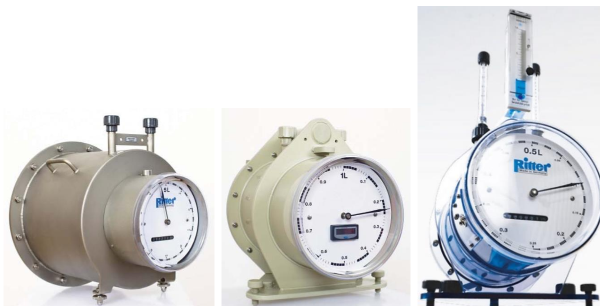
Obr. 5 – Různá provedení laboratorních bubnových plynoměrů značky Ritter, zdroj (Dr.-Ing. Ritter Apparaterbau, 2023)
