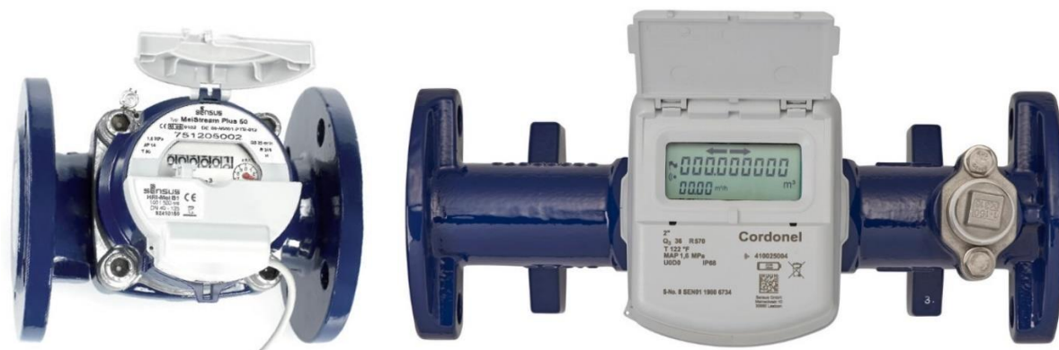
Obr. 30 – Průmyslové vodoměry: mechanický s dílčími analogovými ukazateli a číselným údajem MeiStream Plus (vlevo) a inteligentní elektronický bez pohyblivých částí s displejem a obousměrnou komunikací Cordonel (vpravo), zdroj (Sensus, 2023)
