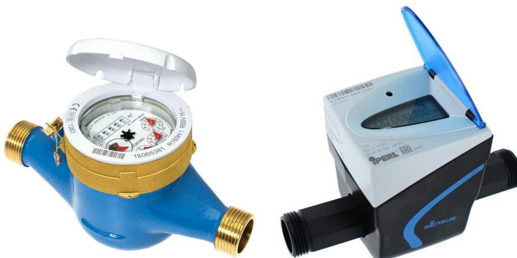
Obr. 29 – Domovní vodoměry: mechanický s dílčími analogovými ukazateli a číselným údajem GMDM-I/SV (vlevo) a inteligentní elektronický bez pohyblivých částí s displejem a obousměrnou komunikací iPerl (vpravo), zdroj (Geos AGT, 2023) a (Sensus, 2023)
